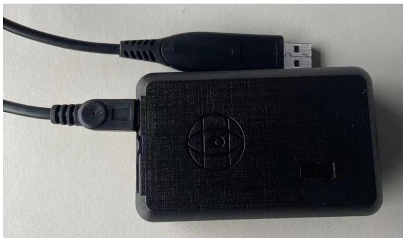
Figura 4 – Conexão do cabo USB/SERIAL
